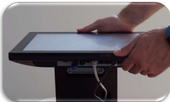
Inclinación de pantalla graduable
