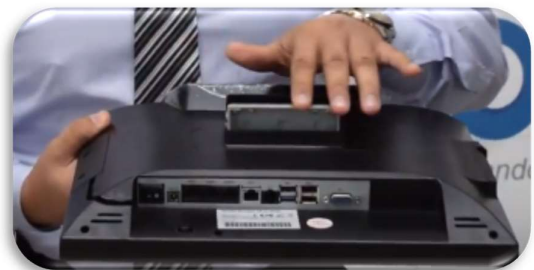
Base desmontable / ubicación de puertos
